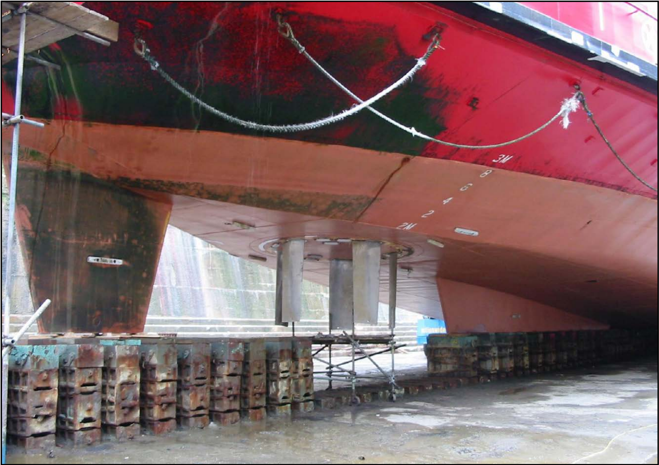
Figure 12: Voith Schneider Propeller unit
